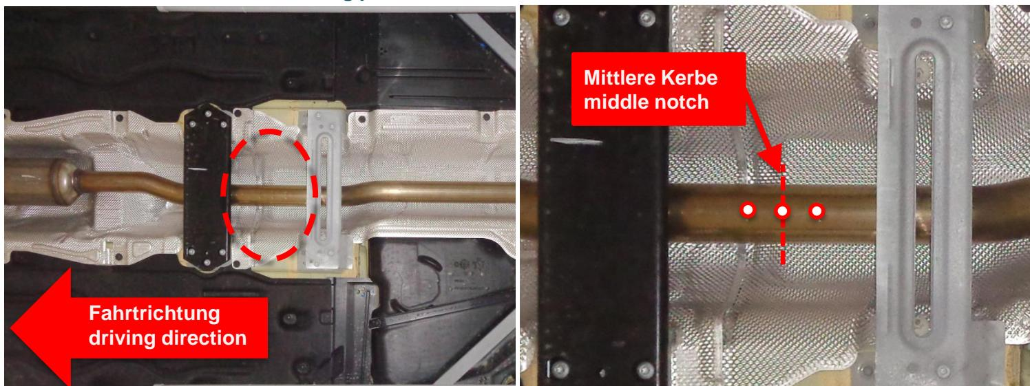
Die Querstreben demontieren. Die Aufhängungsgummis aushängen und den serienmäßigen Endschalldämpfer abnehmen.
