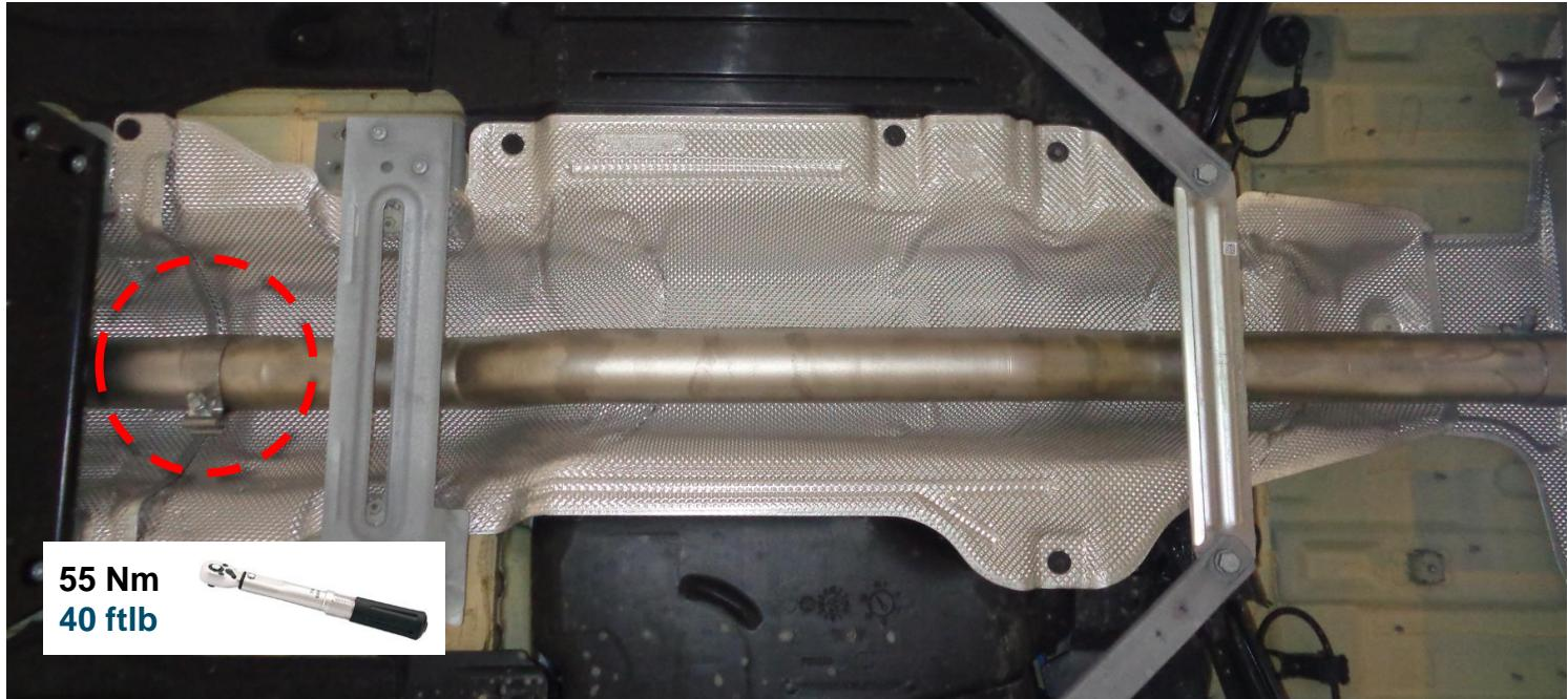
Den REMUS Sportschalldämpfer am Verbindungsrohr montieren und die Gummliaufhängungen an den Befestigungspunkten der Karosserie einhängen. Den REMUS Endrohrbogen am Sportschalldämpfer montieren. Die REMUS Endrohre am REMUS Sportschalldämpfer montieren, die Querstreben wieder anbringen.
